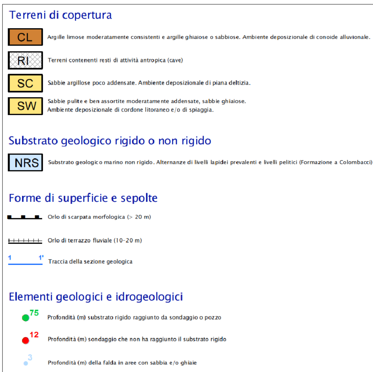
Figura 8.1 – Stralcio della legenda della <<Carta geologico-tecnica>> elaborata per lo studio di microzonazione sismica di Cattolica.
