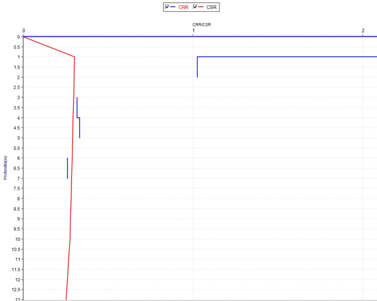
Infine si riporta su grafico a dispersione il coefficiente di sicurezza con la profondità e calcolando quindi il potenziale di liquefazione
