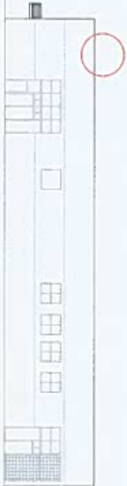
Posizione di installazione pannelli solari su tetto piano in corrispondenza della centrale termica
